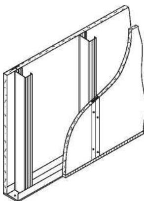
Перегородки поэлементной сборки с обшивкой стекло-магнезитовыми листами являются противопожарными конструкциями, предназначенными для применения в жилых, общественных и производственных зданиях, в которых:
