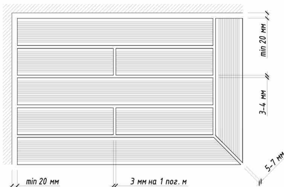
Рис. 6.2. Зазоры укладки террасной доски
