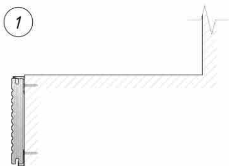
Рис. 7.1. Фиксация подступёнка начальной и конечной клеммами
