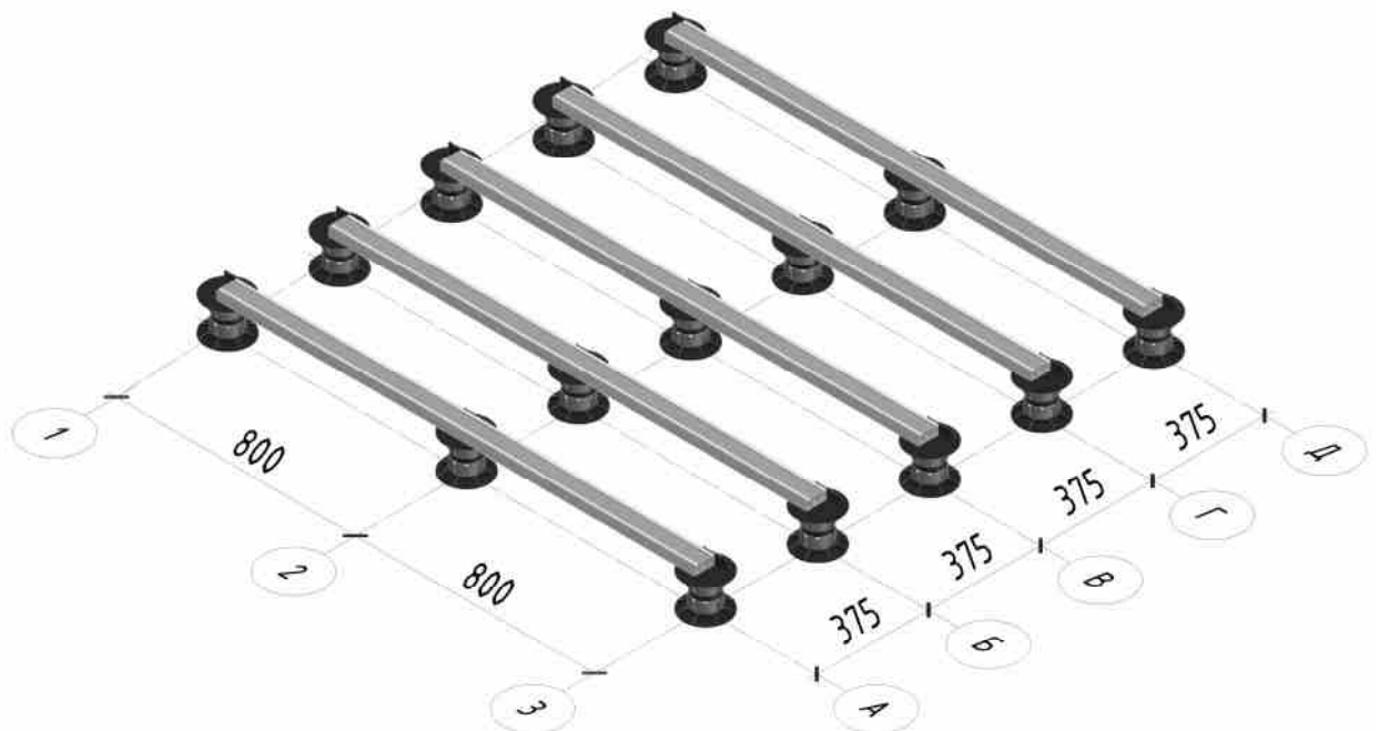
Рис. 3.1. Схема расположения регулируемых опор при использовании алюминиевой лаги 69
