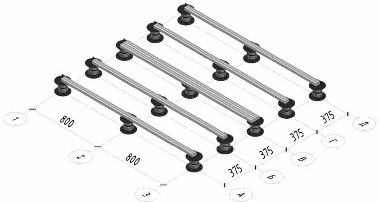
Рис. 3.2. Схема расположения регулируемых опор при использовании алюминиевой лаги 75
